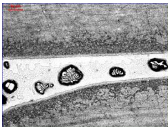
Рис. 3. Паяный шов ( \times 200 ) со стороны входной галтели с зазором 90–100 мкм
