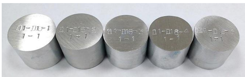
Рис. 2. Комплект стандартных образцов состава сплавов алюминиевых Д1, Д16
