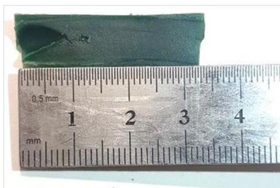
Рис. 5. Разрезанный образец из модельного состава Green Verde фирмы Castaldo
