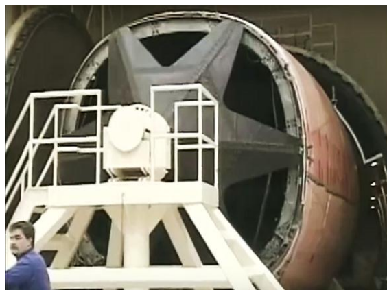
Рис. 2. Формование секции фюзеляжа самолета 787
