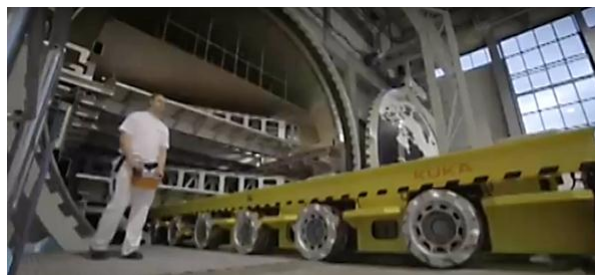
Рис. 1. Формование панелей крыла самолета А-350
