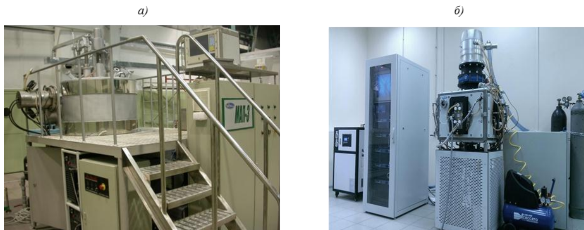
Рис. 1. Внешний вид промышленной ионно-плазменной установки МАП-3 для вакуумно-дугового нанесения (а) и магнетронной установки SEO-TEC K71 – «Квадро» для магнетронного среднечастотного осаждения (б)
