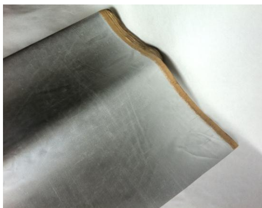
Рис. 3. Внешний вид тканепленочного материала ВРТ-9 с теплоотражающим покрытием ВЭ-72
