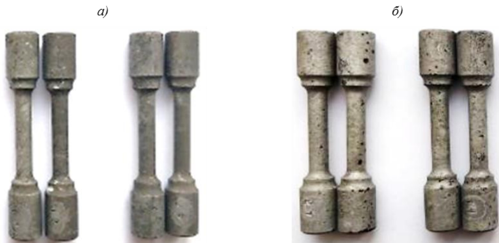
Рис. 4. Внешний вид синтезированных образцов из сплава AlSi10Mg с добавками Cu, Zr, Ce после 30 сут испытаний при переменном погружении в 3%-ный раствор NaCl:
