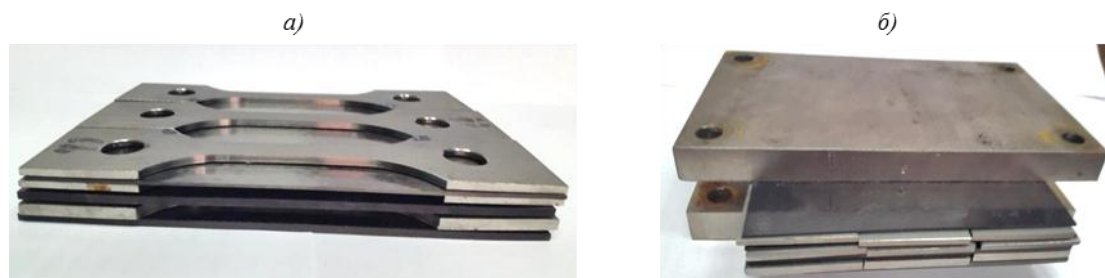
Рис. 5. Образцы из сплавов ВТ23М и ВТ43, послойно уложенные с углепластиком, в исходном состоянии (а) и после проведения климатических испытаний (б)
