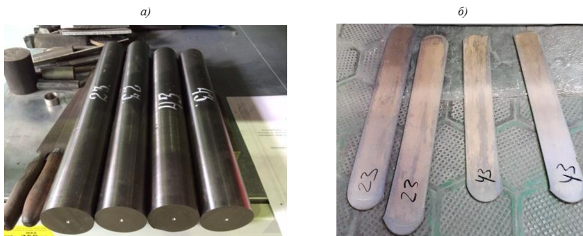
Рис. 3. Прутки \varnothing 60 мм (а) и листы (б) после прокатки до толщины 10 мм из сплавов ВТ23М и ВТ43
