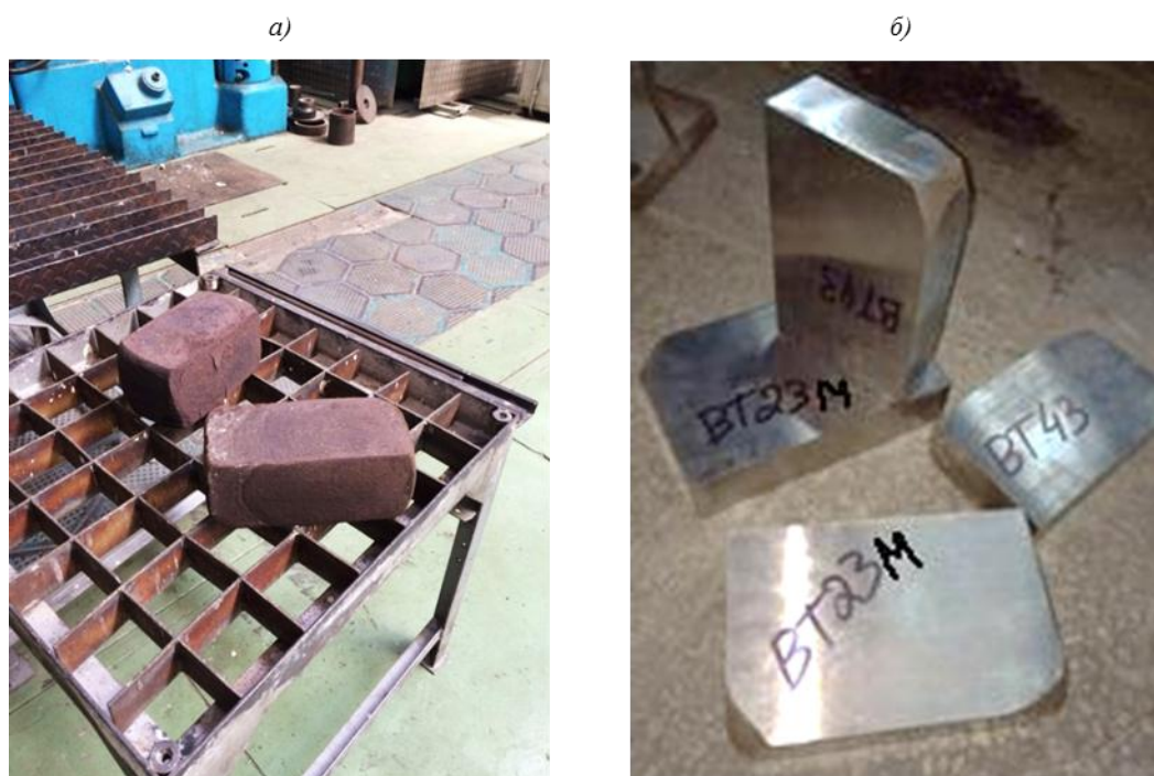
Рис. 2. Сутунки послековки (а), после резки и обточки (б)
