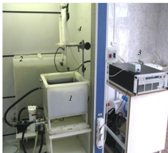
Рис. 1. Лабораторная установка электролитно-плазменной обработки поверхности:
