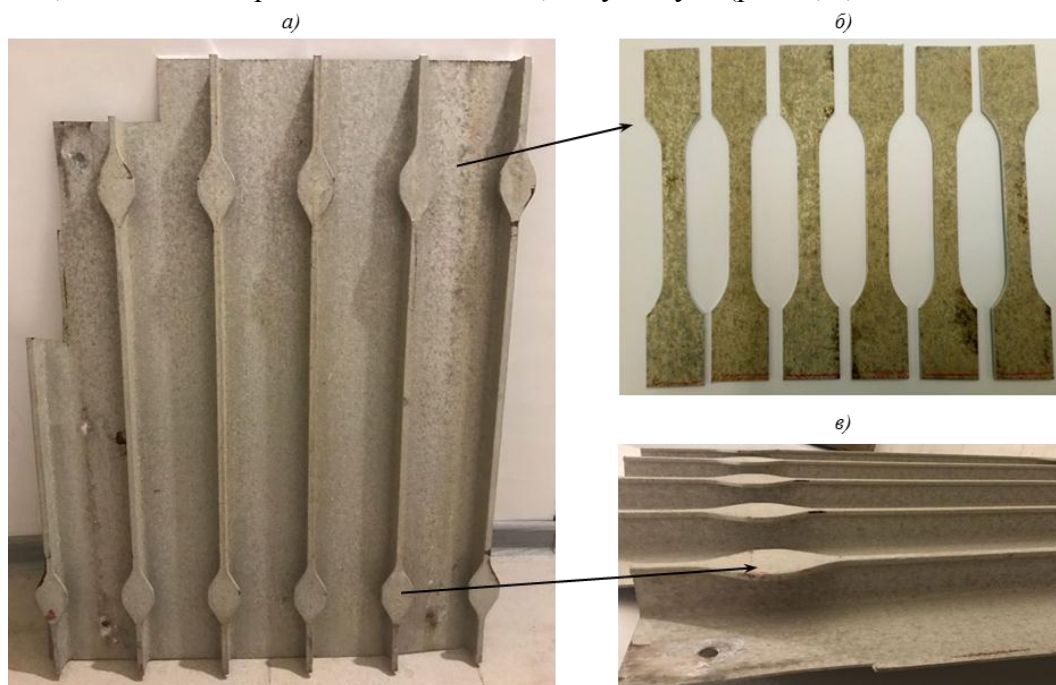
Рис. 6. Панель с ребрами жесткости из сплава В95о.ч.-Т2:
