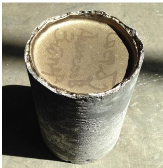
Рис. 6. Внешний вид слитка деформируемого интерметаллидного титанового орто-сплава, легированного иттрием, до механической обработки
