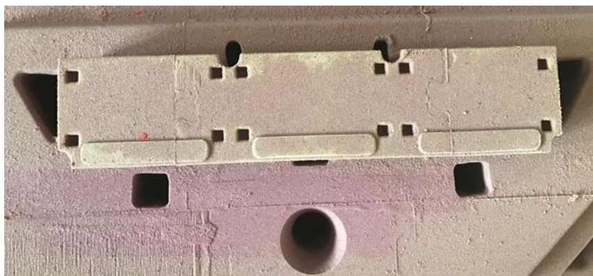
Рис. 2. Часть формы детали «Корпус» из холоднотвердеющей смеси
