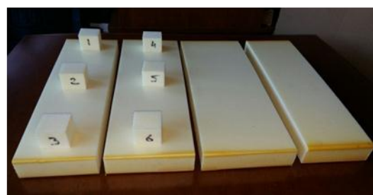
Рис. 1. Расположение на пеноблоке образцов для испытаний
