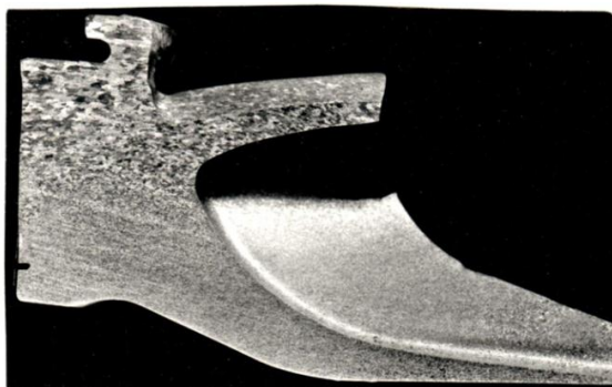
Рис. 3. Макроструктура темплета крыльчатки – разнoзернистость
