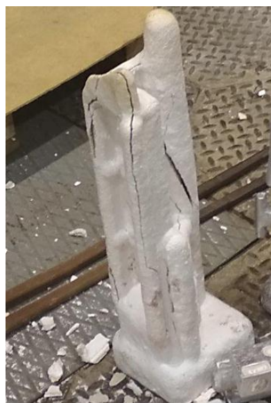
Рис. 5. Треснувшая при заливке металла оболочковая форма с количеством слоев менее 6
