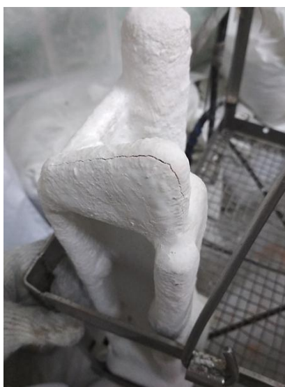
Рис. 2. Треснувшая при вытопке модельного состава оболочковая форма
