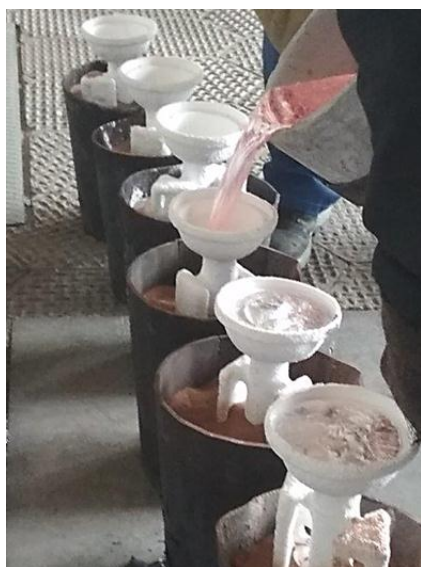
Рис. 4. Оболочковые формы, заформованные в опорный наполнитель
