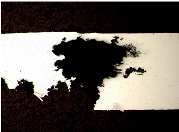
Рис. 7. Межкристаллитная сквозная коррозия сплава Д16-Т в зоне сопряжения поверхностей
