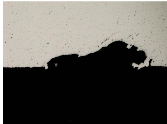
Рис. 8. Местная коррозия стали 08X17 глубиной 0,4 мм в зоне сопряжения поверхностей
