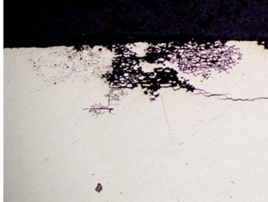
Рис. 1. Межкристаллитная коррозия ( \times 100 ) в образце при четырехточечном изгибе алюминиевого сплава 1441 после 53 сут экспозиции при постоянном погружении в морскую воду (зона разлома)
