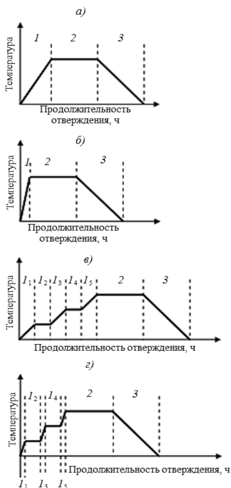
Схема режимов отверждения: одноступенчатый (а, б) и трехступенчатый (в, г) при использовании электрической печи (а, в) и СВЧ-нагрева (б, г)
