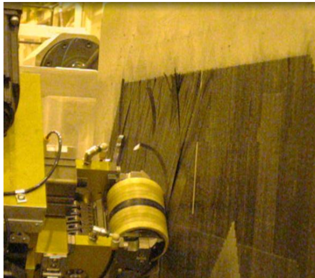
Рис. 3. Отслаивание препрега от подложки
