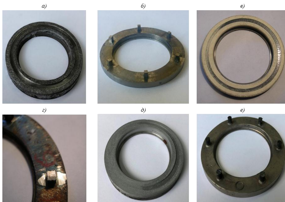
Рис. 3. Внешний вид образцов уплотнительных материалов и имитаторов деталей ротора после испытаний на врезание:
