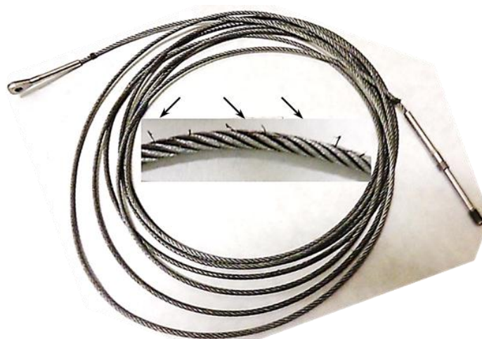
Рис. 10. Общий вид троса и дефектной области
