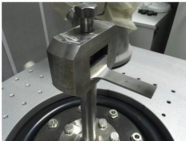
Рис. 2. Внешний вид оснастки с закрепленным образцом на вибростенде ETS Solution MPA 403-M124M
