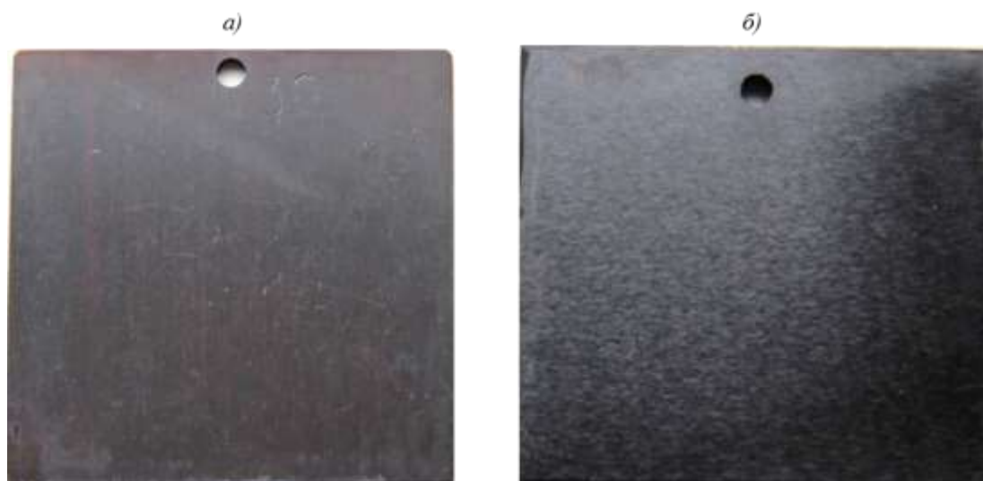
Рис. 2. Внешний вид образцов из стали 30ХГСА с химическим оксидным покрытием (а) и с молибдатной пленкой (б)
