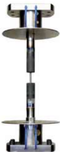
Рис. 2. Захваты для высокотемпературных испытаний на малоцикловую усталость при «мягком» и «жестком» циклах нагружения, изготовленные из жаропрочных никелевых сплавов
