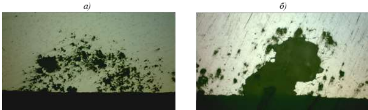
Рис. 8. Результаты металлографического исследования сплава 1163-Т после проведения провоцирующей термообработки на МКК (при 150^\circ\text{C} в течение 10 ч):
