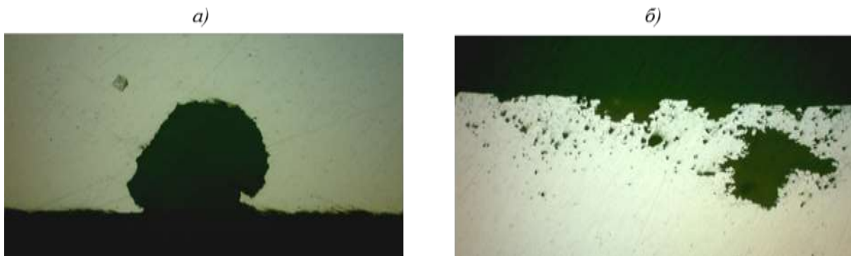
Рис. 6. Результаты металлографического исследования сплава 1163-Т после проведения провоцирующей термообработки на МКК (при 150°C в течение 10 ч) и анодного растворения в растворах:
