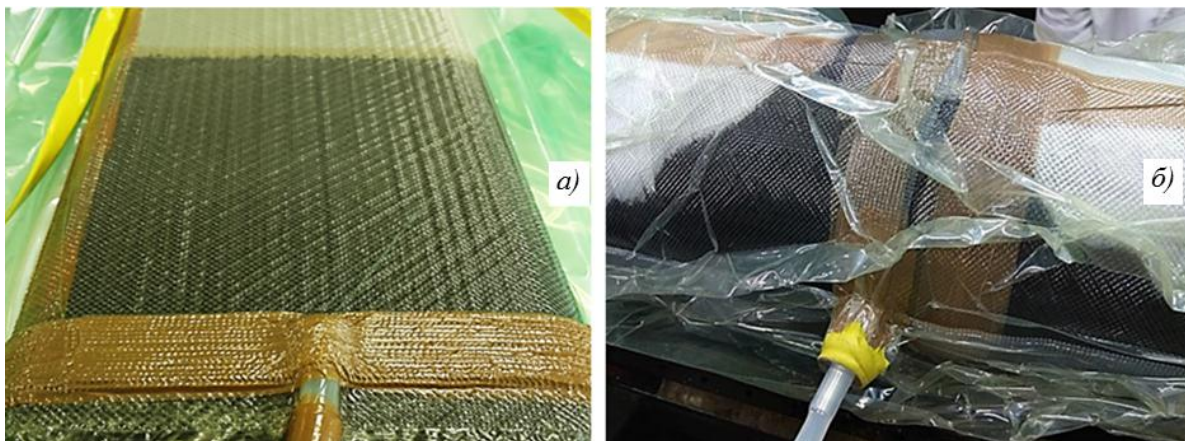
Рис. 2. Изготовление плоского (а) и цилиндрического (б) образцов из углепластика на основе объемно-армирующей плетеной преформы
