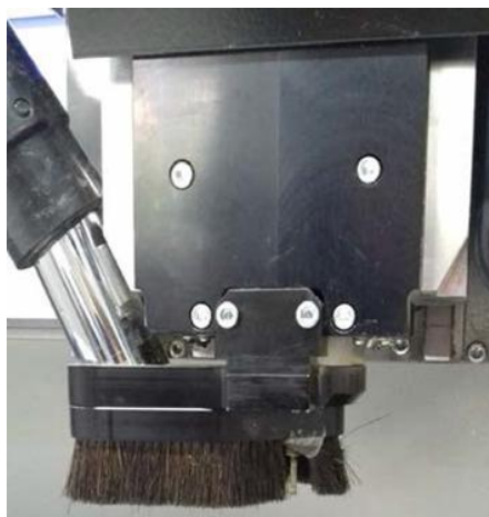
Рис. 13. Система отвода пылевидной стружки и вредных веществ
