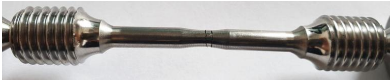
Рис. 6. Характер разрушения образца с корсетной рабочей частью
