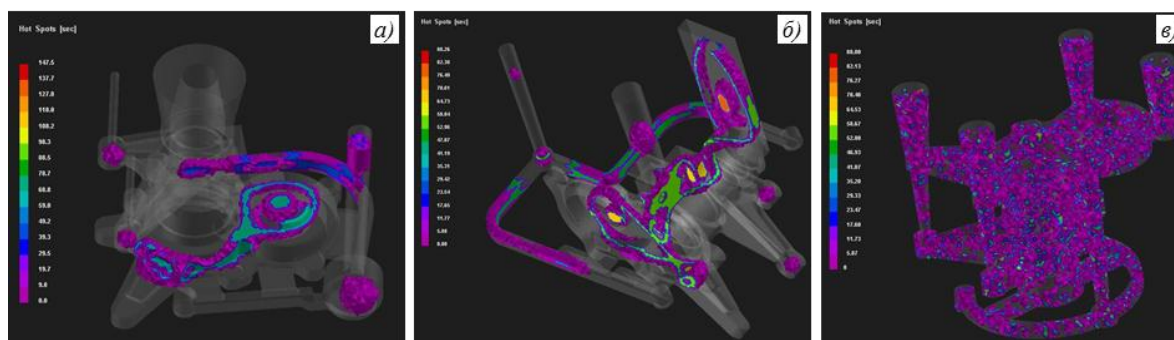
Рис. 5. Распределение тепловых узлов при расположении отливки по вариантам I (а), II (б) и III (в)
