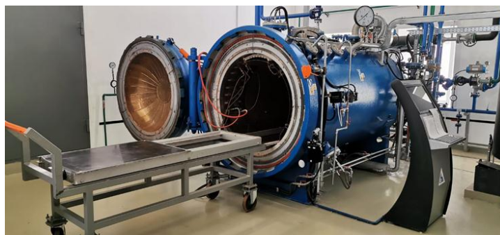
Рис. 2. Автоклав для формования изделий из ПКМ
