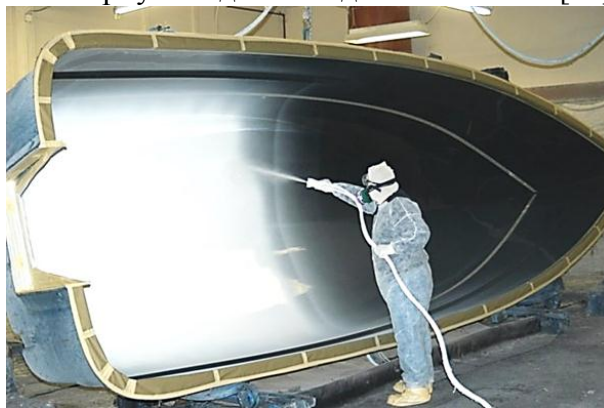
Рис. 12. Формование корпуса лодки методом напыления [35]
