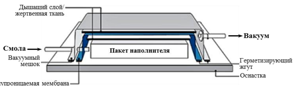
Рис. 7. Схема изготовления детали методом вакуумной инфузии с использованием полупроницаемой мембраны [23]
