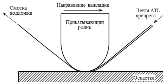
Рис. 4. Упрощенная схема процесса автоматизированной выкладки ленты [17]
