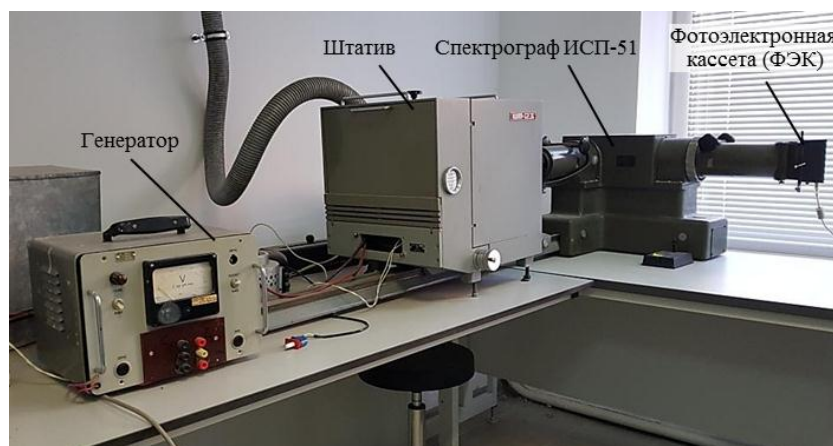
Рис. 4. Спектральный комплекс на основе спектрографа ИСП-51, модернизированного ФЭК
