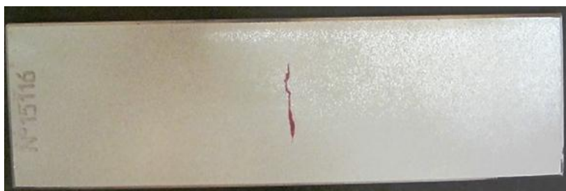
Рис. 1. Контрольный образец, изготовленный по ГОСТ 18442–80
