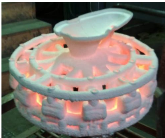
Рис. 6. Общий вид керамической формы после предварительной прокалки перед загрузкой в вакуумную плавильную установку ВИПЭ-3
