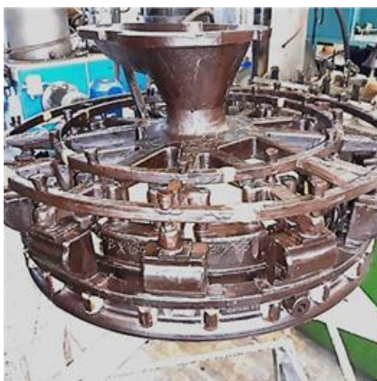
Рис. 4. Общий вид модельного блока с литниково-питающей системой
