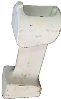
Рис. 3. Общий вид керамического стержня для оформления внутренней полости
