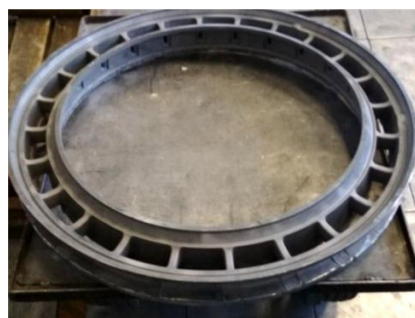
Рис. 9. Общий вид отливки типа «диффузор» после удаления элементов литниково-питающей системы и термической обработки
