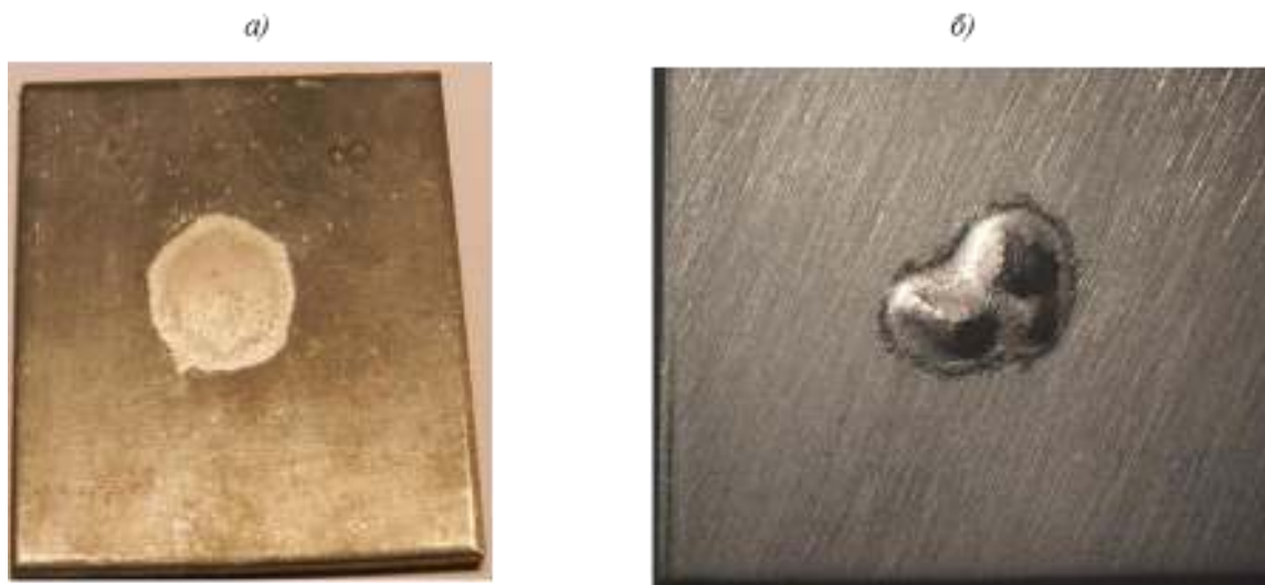
Рис. 1. Внешний вид проб на растекаемость припоя ВПр27: а – удовлетворительная; б – неудовлетворительная
