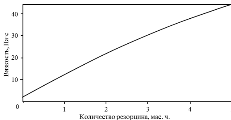
Рис. 2. Зависимость вязкости композиции на основе смолы ЭХД с отвердителем UR-500 (соотношение 100:6) при 70°С от содержания резорцина
