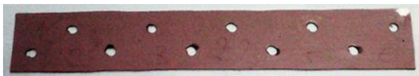
Рис. 5. Вид образцов ленточного герметика после демонтажа
