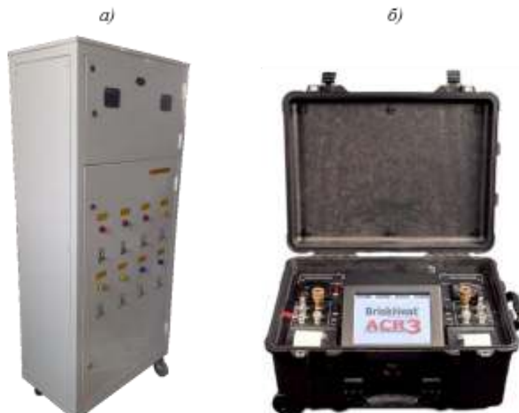
Рис. 1. Восьмиканальная система управления крупногабаритными обогреваемыми оснастками мощностью до 70 кВт (а), мобильная система управления процессом формования, предназначенная для ремонта изделий из ПКМ (б)
