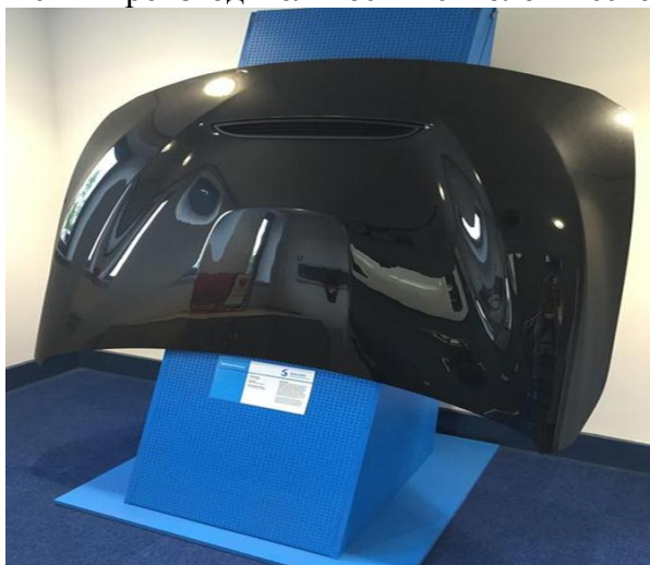
Рис. 2. Капот автомобиля BMW M4 GTS, выполненный из углепластика на быстроотверждаемом связующем марки MTR 760 компании Solvay
