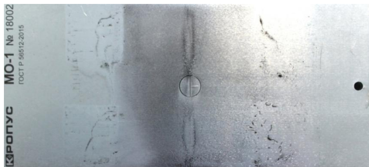
Рис. 3. Контрольный образец МО-1 [18]
