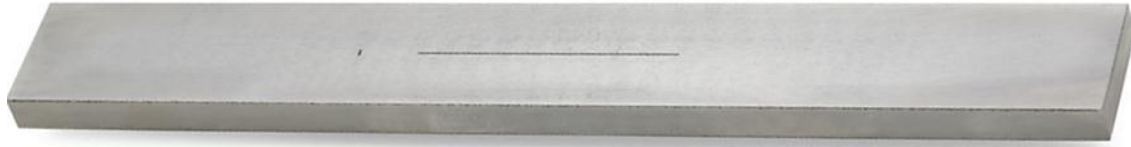
Рис. 7. Контрольный брусок для магнитопорошкового контроля (Magnetic Particle Test Bar) [19]
