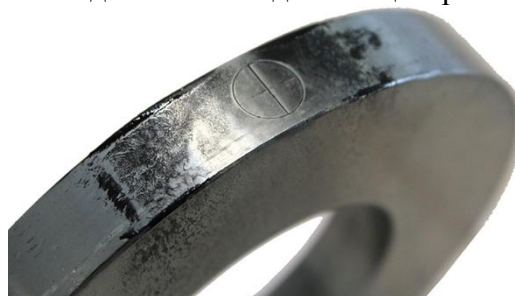
Рис. 6. Контрольный образец МО-4 [18]
