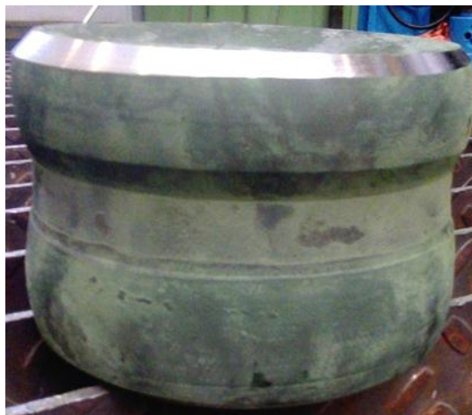
Рис. 4. Заготовка диска после подпрессовки в контейнере
