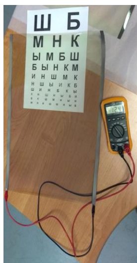
Рис. 8. Образец ПЭТФ-пленки с нанесенным ИТО-покрытием
