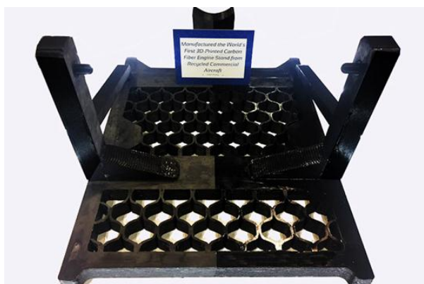
Рис. 3. Стенд двигателя, изготовленный из переработанного углеродного волокна [21]
