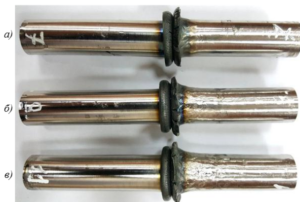
Рис. 1. Сварные образцы при сочетании материалов «отливка + деформированный полуфабрикат», выполненные на экспериментальных режимах 4 (а), 5 (б) и 6 (в) (отливки справа)
