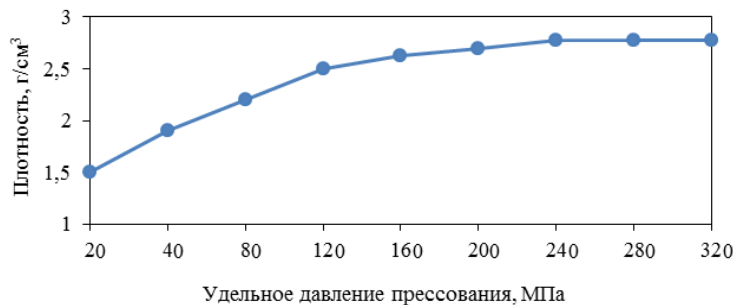
Рис. 6. Зависимость плотности металлического композиционного материала от удельного давления прессования
