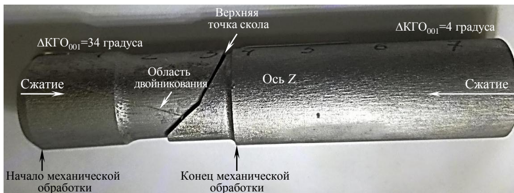
Рис. 1. Литая заготовка для изготовления образца для механических испытаний, разрушенная при механической обработке
