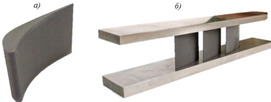
Рис. 8. Прототип неохлаждаемой сопловой лопатки турбины из ККМ ( a ) и экспериментальный конструктивно-подобный образец сектора соплового аппарата ( б )
