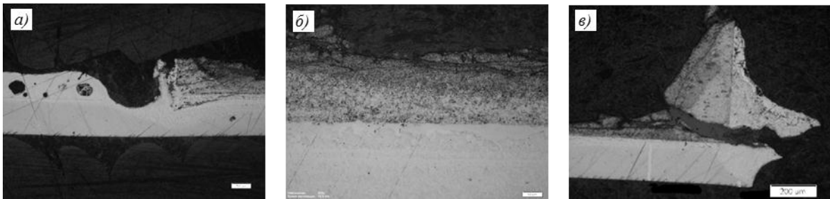
Рис. 3. Микроструктура паяного соединения сплава ЭП648 с ККМ системы \text{SiC-SiC}_w\text{-B}_4\text{C-AlN} , выполненная припоем ВПр4: a – входная галтель ( \times 100 ); б – середина паяного шва ( \times 200 ); в – выходная галтель ( \times 50 )
