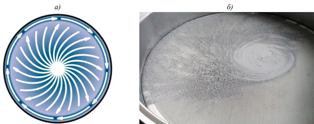
Рис. 3. Траектории движения порошка по ситовому полотну в виде спирали: а – схема движения; б – движение по ситовому полотну в процессе отсева
