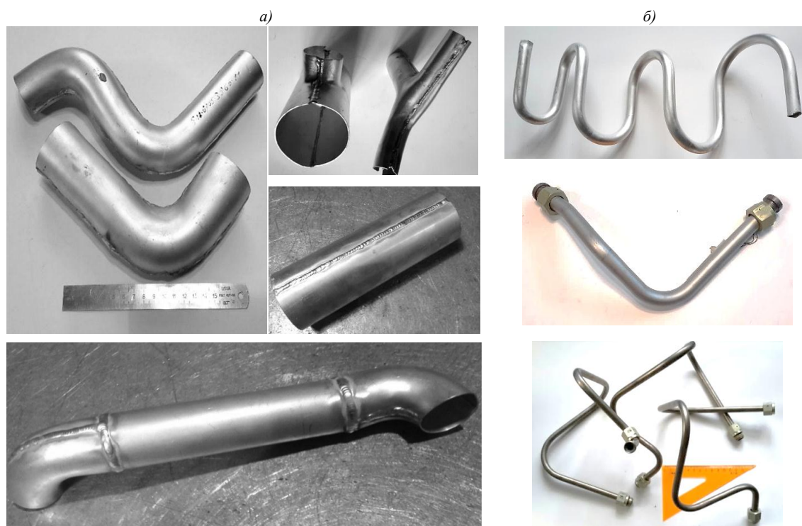
Рис. 8. Элементы трубопроводов со сварными (а) и разъемными (б) соединениями листов и труб из высокотехнологичного сплава В-1341
