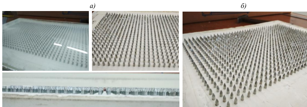
Рис. 5. Специальная оснастка для перфорирования углепластика: а – вид сбоку; б – вид сверху
