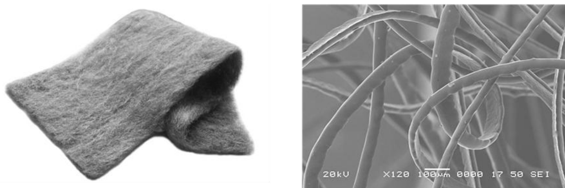
Рис. 2. Пористо-волоknистый металлический материал из сплава X23Ю5, полученный методом экстракции висящей капли расплава, и его структура
