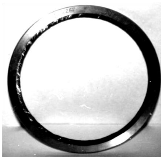
Рис. 4. Опытное щеточное уплотнение, разработанное в АМНТК «Союз»
