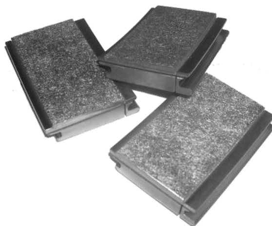
Рис. 1. Детали авиационного двигателя с истираемым уплотнительным материалом из волокон системы Fe(Ni)–Cr–Al–Y
